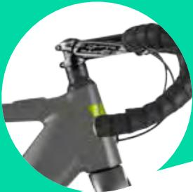
BATTERIA INTERNA AL TELAIO
