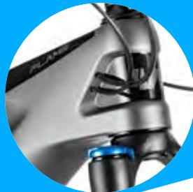
BATTERIA INTEGRATA AL TELAIO
